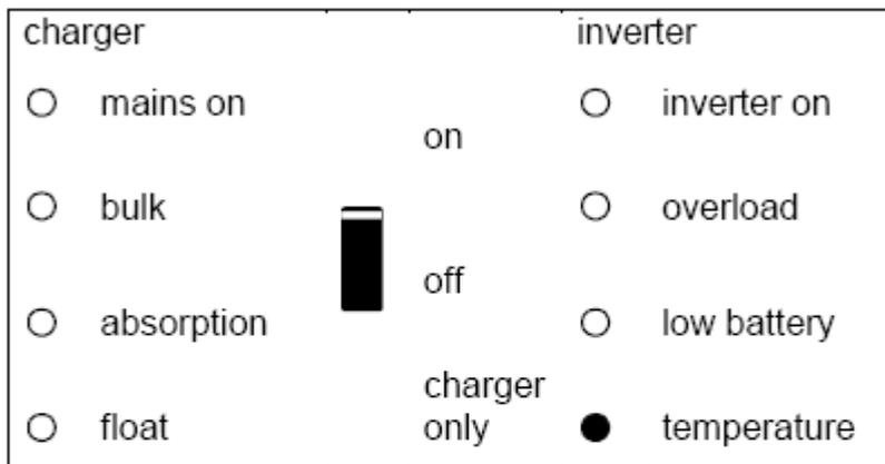
Инвертор выключен из-за чрезмерно высокой температуры внутри
