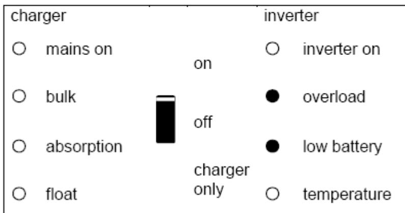
Инвертор выключен из-за чрезмерно высокой пульсации напряжения на аккумуляторной батарее.
