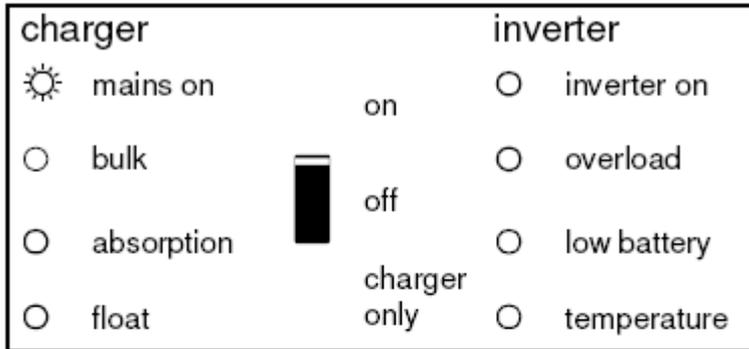
Ввод AC подключен к сети. Выходной ток AC равен предварительной установке максимального входного тока. Ток заряда уменьшен до 0А.
