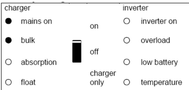
Напряжение переменного тока от сети подключено к AC входу, и зарядное устройство работает в фазе наполнения.
