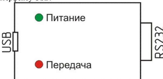
Рис. 2. Расположение индикаторов на корпусе преобразователя.
