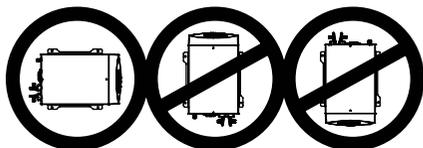
Не монтируйте инвертор терминалами постоянного тока вверх или вниз.
