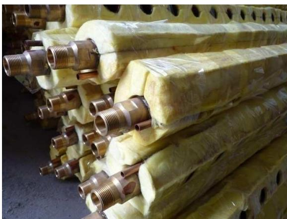
Утепление минеральной ватой до 75 мм.
