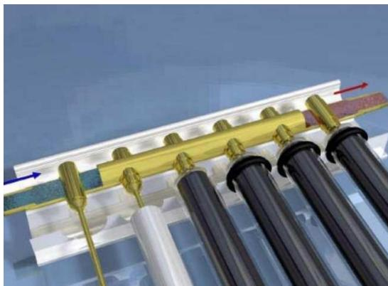
Конденсатор служит для передачи тепла, но он не контактирует с теплоносителем. Тепло передается от конденсатора медному теплообменнику, а затем в проходящую жидкость.
