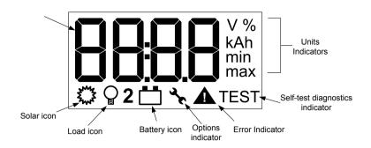
**Дисплей** – четырехзначный цифровой дисплей показывает значения напряжения, силы тока и температуры.
