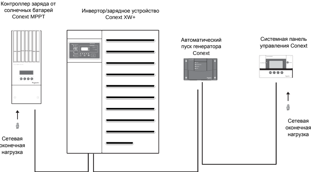
Рис. 4-1. Сетевая система Xanbus (пример)
