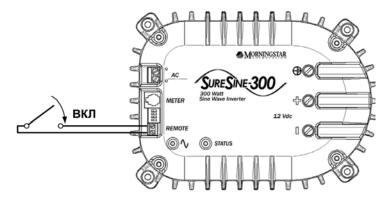
Если дистанционное включение инвертора не используется, необходимо замкнуть контакты дистанционного включения. Используйте прилагаемую перемычку.
