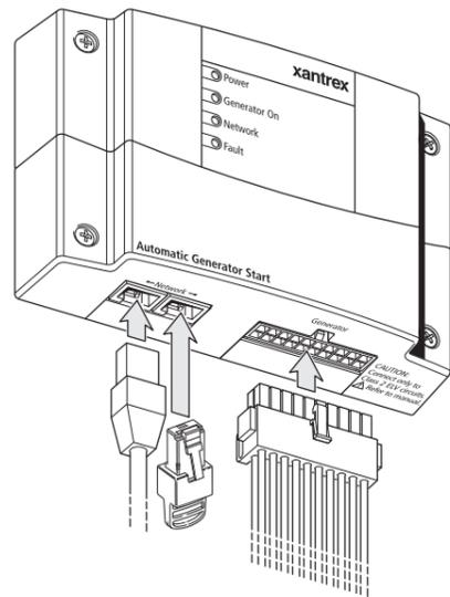
Для подключения XW AGS к Xanbus, вставим разъем кабеля Xanbus (стандартный сетевой кабель Ethernet с прямым включением) в один из сетевых портов, расположенных на нижней панели XW AGS. Подключите другой конец этого же кабеля к следующему в цепочке устройству, работающему с Xanbus. В зависимости от состава системы передачи энергии Xanbus, возможно наличие следующих опций для другого соединителя, расположенного на устройстве XW AGS:
